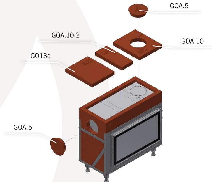
Verkleben Sie den Deckel des Mantels mit den Seitenteilen. Verwenden sie dazu den ORTNER Versetzmörtel HK.
