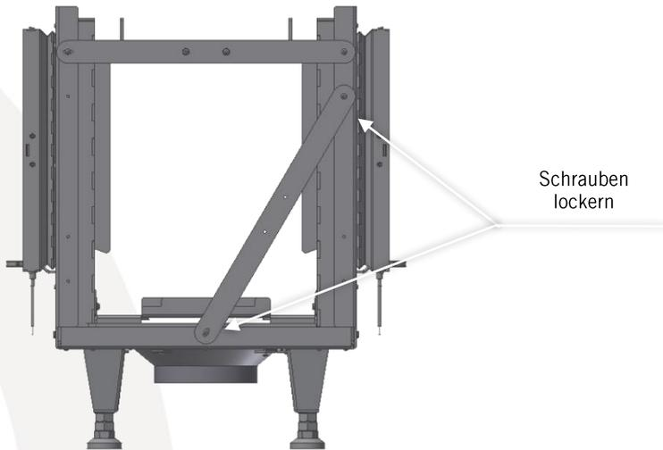
Stellen Sie das Grundgestell auf, richten Sie den Bodenteil in die Waage, und schließen Sie bei Bedarf den Aluflexschlauch für die Verbrennungsluftversorgung an.
