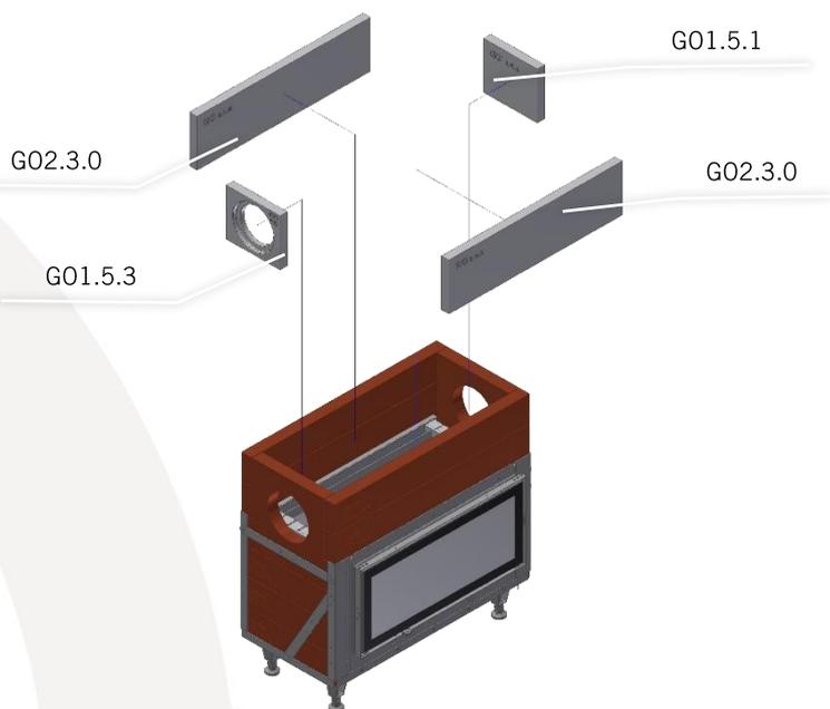
Versetzen Sie die Teile der Nachverbrennungskammer trocken. Bei nicht geschlossenen Fugen (abhängig von der Fugenstärke beim Aufbau der roten Mantelsteine) sind die Fugen mit Keramikfaser abzudichten. Die Nachverbrennung jedoch nicht untereinander zu Verkleben
