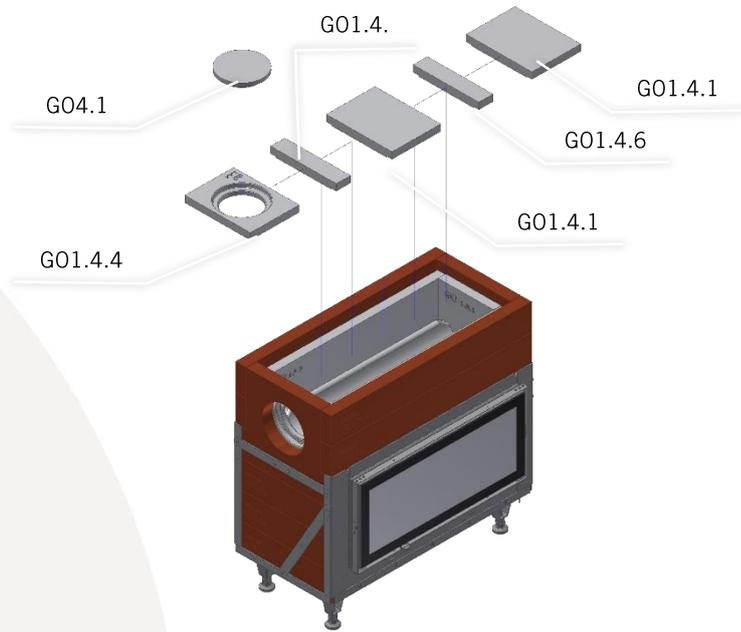
Positionieren Sie nun die Abdeckung der Nachbrennkammer, je nach Position des Ausbrandes.
